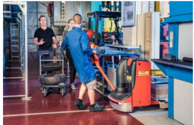
© Ein speziell entwickelter Näherungssensor dient dazu, den Nutzer vor Quetschungen vor allem im Fußbereich zu schützen. Der Sensor erkennt, wenn sich der Bedienende zu nah im Gefahrenbereich vor dem Fahrzeug befindet und bremst dieses ab.
